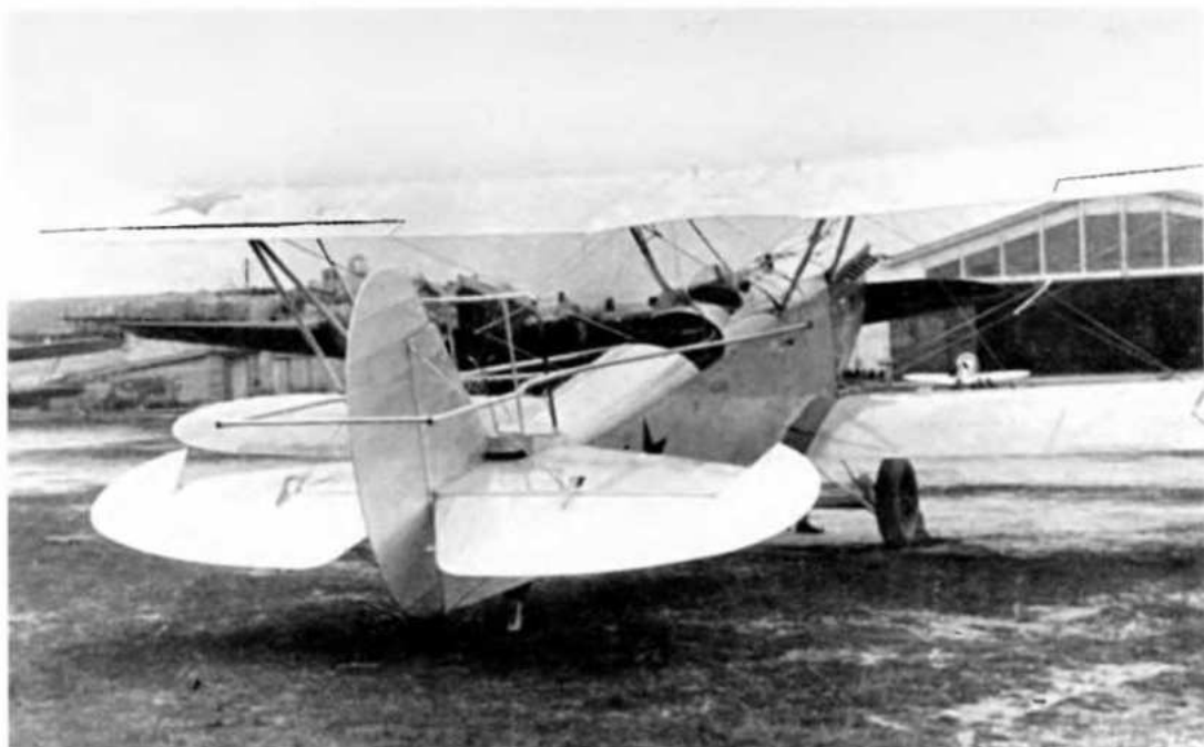
Р-5, оборудо- ванный для буксировки десантного планера «Яков Алкснис», 1934 г.
