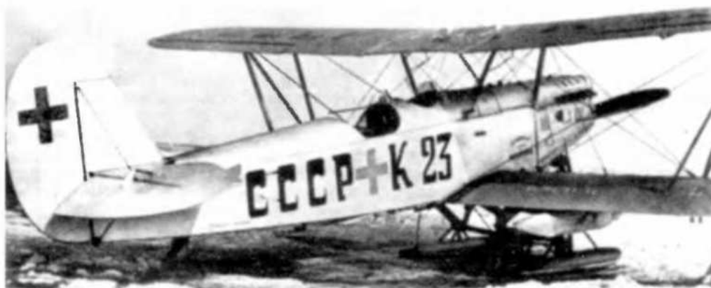
Санитарный П-5 из эскадрильи им. М.И. Калинина, принадлежавшей наркомату здравоохранения. Под нижним крылом — зачехленные носилки
