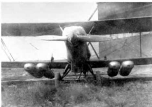
П-5 с четырьмя грузовыми кассетами («ящиками»), август 1935 г.
