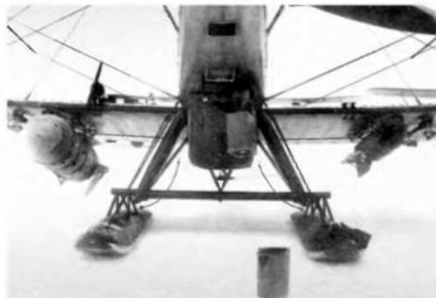
Р-5 с поясной подвеской под крылом: справа ротативно-рассеивающая бомба (одноразовая кассета) РРАБ-250, слева — фугасная бомба ФАБ-250
