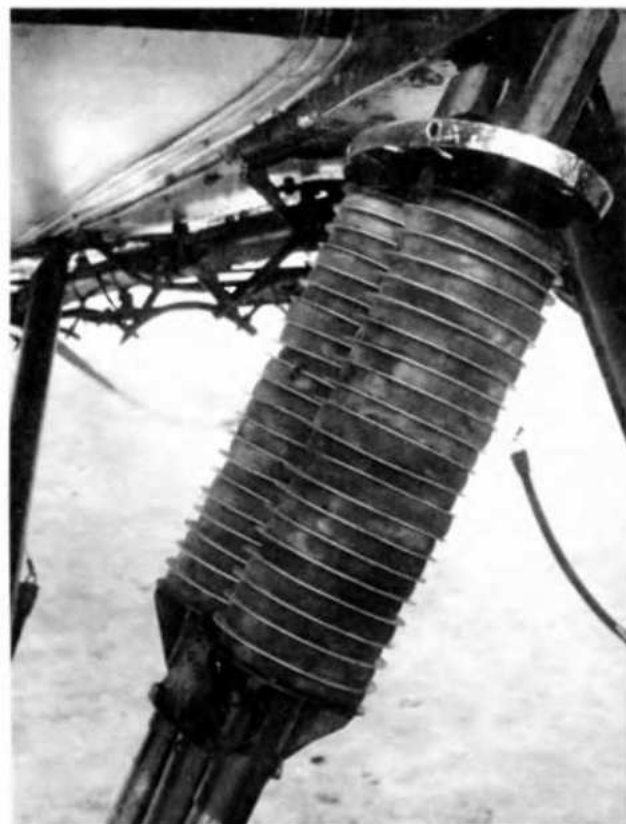
Одним из основных дефектов Р-5 1-й серии была деформация резиновых пластин амортизатора. На снимке — правый амортизатор самолета № 4141 со снятым обтекателем. Хорошо видны смятые и перекошенные пластины
