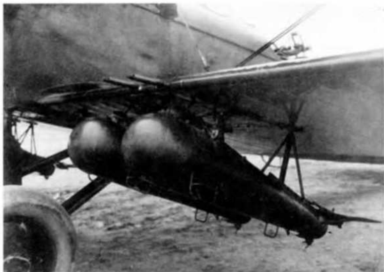
Выливные приборы ВАП-4м, подвешенные под штурмовик СССР
