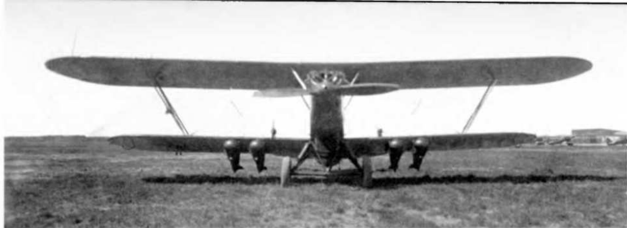
Р-5 с четырьмя зажигательными приборами ЗАП-4 на испытаниях системы «Огненный дождь», июнь 1936 г.
