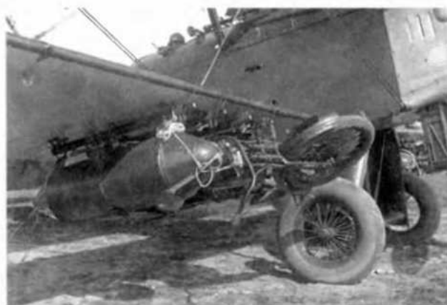
Подвеска мотоцикла «Харлей-Дэвидсон» с мотором в 3 л.с. под Р-5
