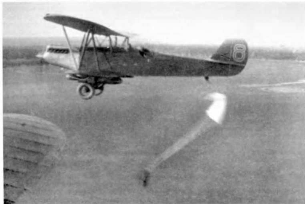
В Экспериментальном институте НКТП было разработано оборудование для прокладки телефонной линии с самолета. Когда весь провод сматывался, на парашюте сбрасывали телефонный аппарат. При необходимости за ним мог последовать оператор-телефонист, сидевший в задней кабине Р-5
