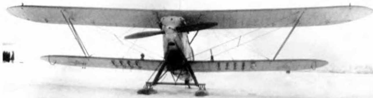
Самолет № 4629 – «эталон 1932 г.» на лыжах во время испытаний в НИИ ВВС, конец 1931 г.
