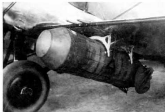
Ротативно-рассеивающая (кассетная) бомба РРАБ-250 на держателях Дер-31 под крылом СССР
