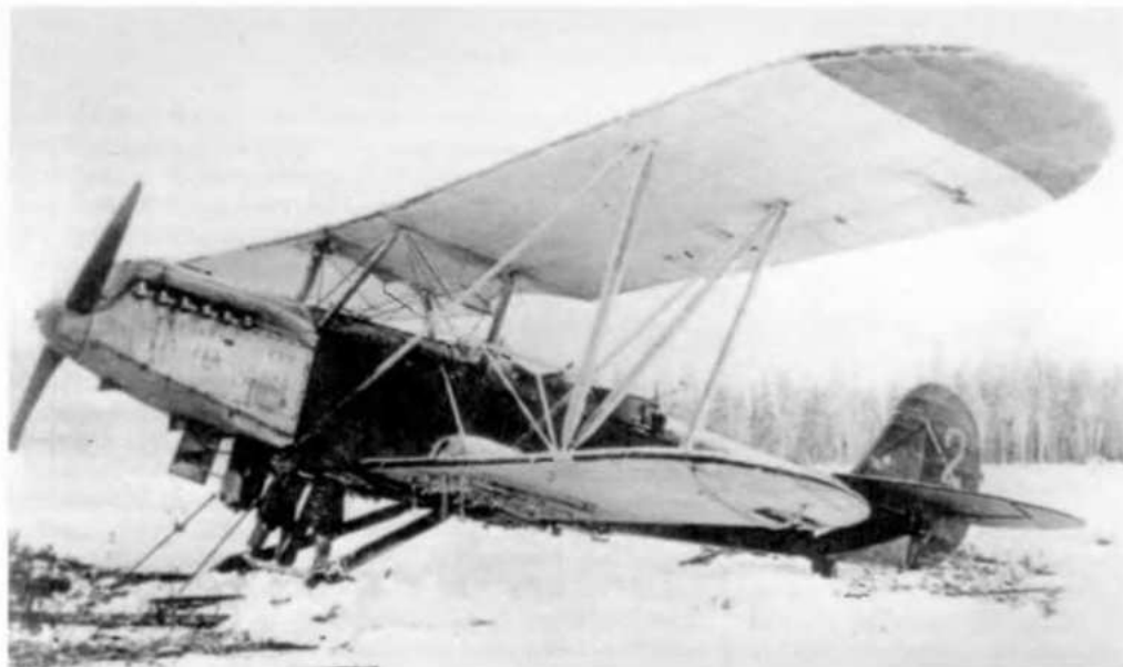
Один из двух Р-5Ш 669-го илбап, совершивших 19 января 1942 г. вынужденную посадку возле Онтаярви в Финляндии; он был захвачен финнами. Обратите внимание на то, что пулеметы из обтекателей на нижнем крыле удалены, и на нестандартную турель
