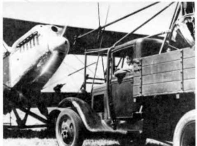
Запуск двигателя при помощи автостартера
