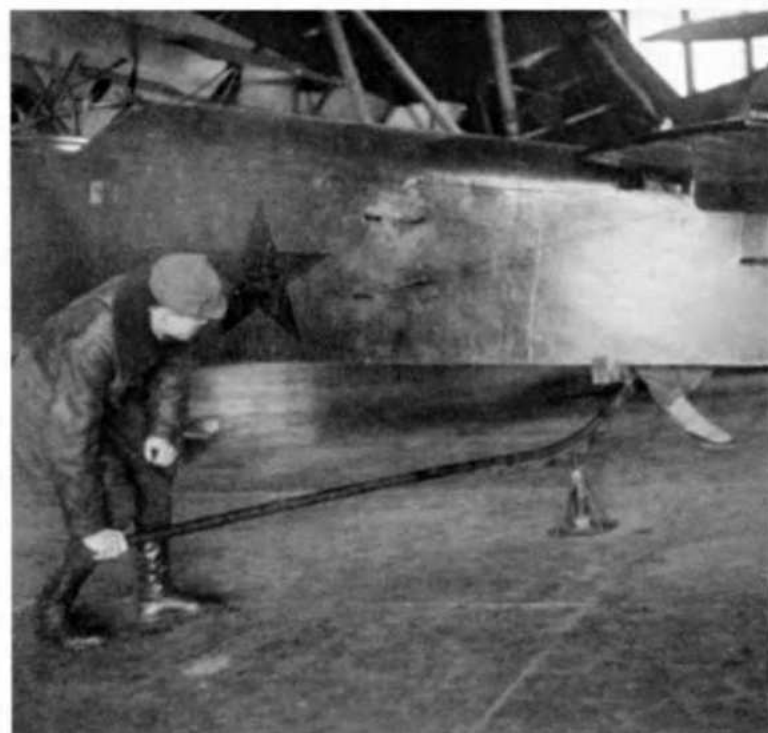
Старший техник Быстров при помощи самодельного приспособления поднимает хвост стоящего в ангаре Р-5, Харьковский военный округ, 1936 г.
