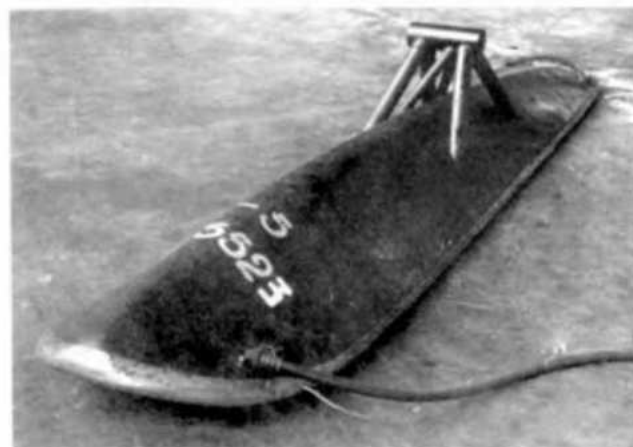
Экспериментальная лыжа треугольного сечения, такие лыжи испытывались в ОЗЛИД ЦАГИ в декабре 1933 г.
