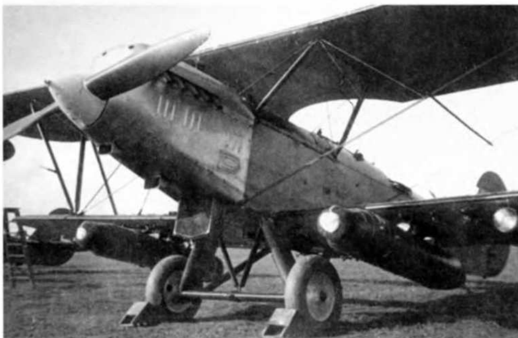
Вверху: этот P-5 пострадал от взрыва бомбы АО-10, сорвавшей- ся с бомбодержа- теля под крылом при взлете, 21 июля 1934 г.
