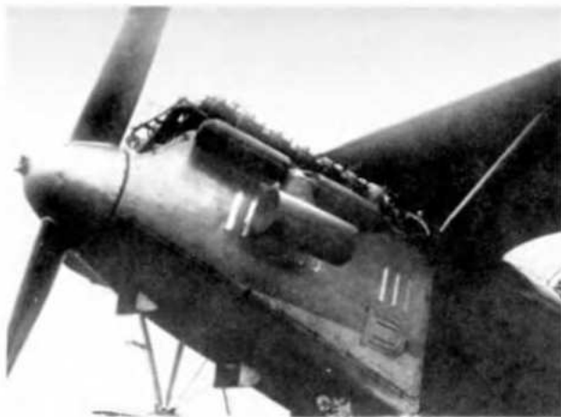
Глушитель конструкции адъютанта Военно-воздушной академии Я. Андрианова
