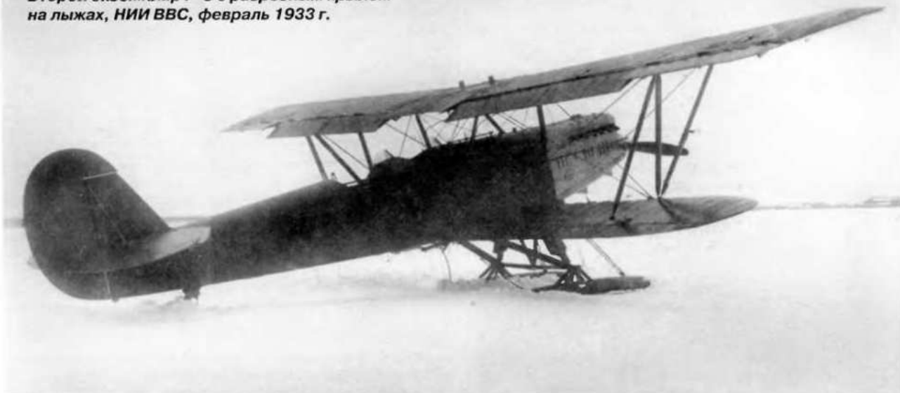
Второй экземпляр Р-5 с разрезным крылом на лыжах, НИИ ВВС, февраль 1933 г.
