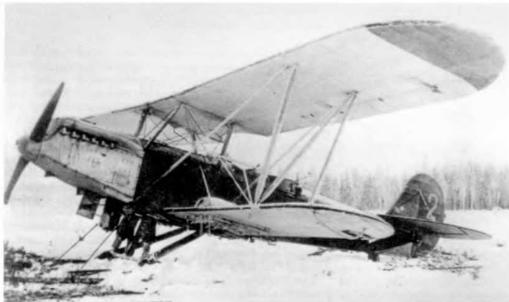
Один из двух Р-5Ш 669-го илбап, совершивших 19 января 1942 г. вынужденную посадку возле Онтарио в Финляндии; он был захвачен финнами. Обратите внимание на то, что пулеметы из обтекателей на нижнем крыле удалены, и на нестандартную турель
