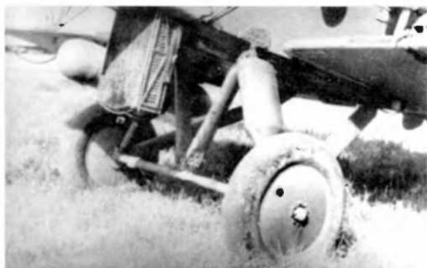
Шасси P-5 выпуска 1934 г. Виден полностью выпу- щенный водяной радиатор
