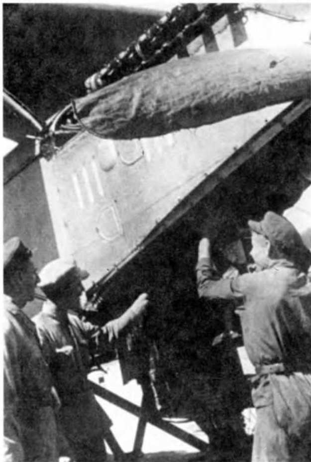
Механики занимаются мотоустановкой. Деревянный винт закрыт чехлом
