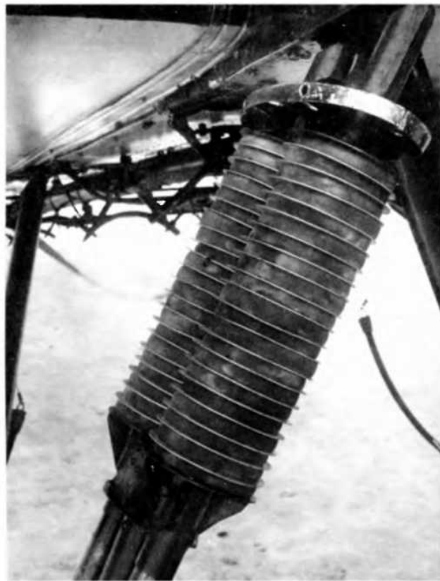
Одним из основных дефектов Р-5 1-й серии была деформация резиновых пластин амортизатора. На снимке — правый амортизатор самолета № 4141 со снятым обтекателем. Хорошо видны смятые и перекошенные пластины
