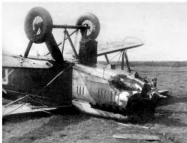
Авария Р-5 авиаотряда ГУАП 20 мая 1933 г. на окраине Рыбинска. Самолет летчика В.В. Егорова скапотировал при посадке на мягком грунте
