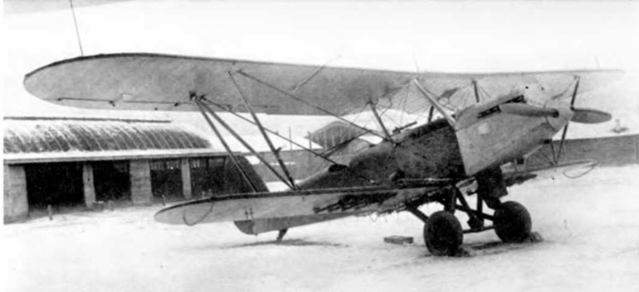
Р-5 выпуска 1934 г. с тормозными колесами. Подкрыльные дуги на месте; возможно, по требованиям из частей их вновь стали монтировать на самолетах
