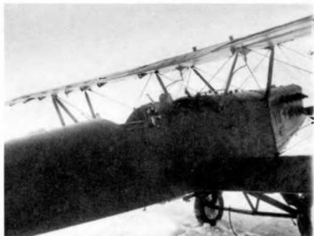
Второй самолет с механизированным крылом на шасси с тормозными колесами, весна 1933 г.
