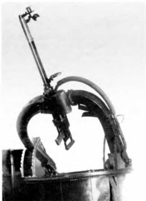
Турель Тур-8 с пулеметом ШКАС образца 1933 г., устанавливавшаяся в задней кабине СССР
