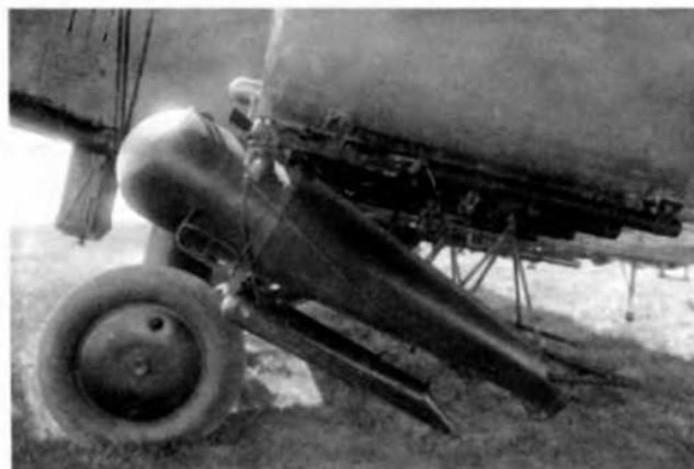
Прибор ЗАП-4 представлял собой выливной химический прибор ВАП-4м, который заправляли гранулированным желтым фосфором в керосине. Эта смесь вспыхивала, соединяясь с дымовой смесью С-4 из нижнего небольшого баллона
