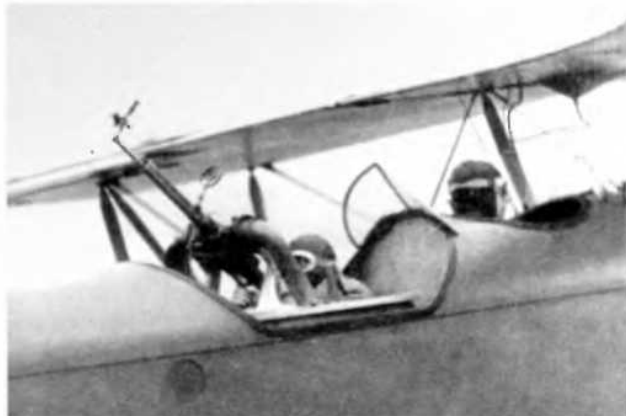
Испытание на P-5 опытной турели с пулеметом ШКАС
