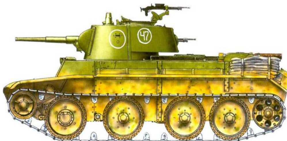
Танк БТ-7 образца 1937 года (с конической башней) из состава 6-й танковой бригады Красной Армии. Халхин-Гол, август 1939 года.
